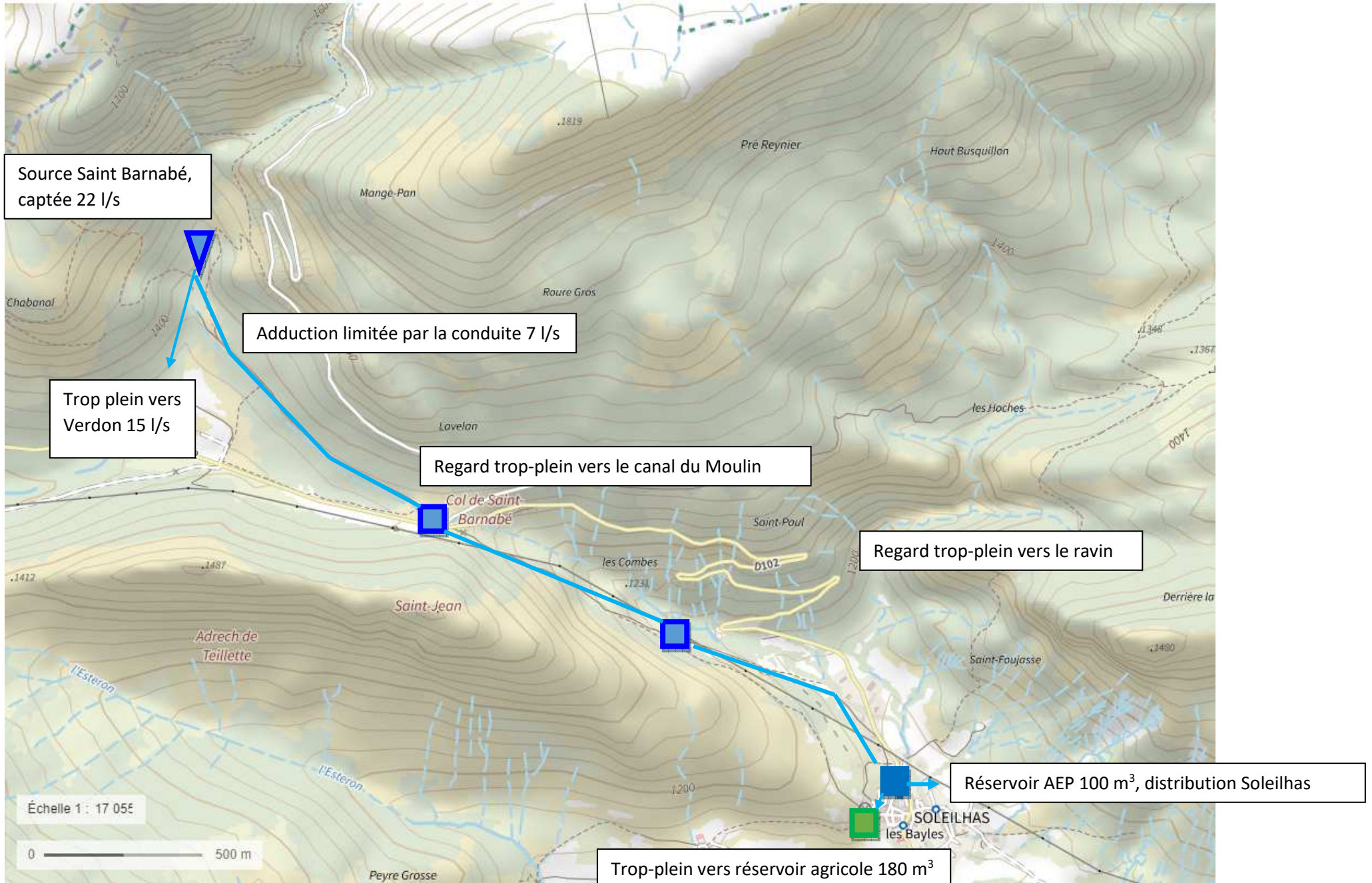
Schéma simplifié du réseau AEP de Soleilhas (mesures cimeo 2017)
